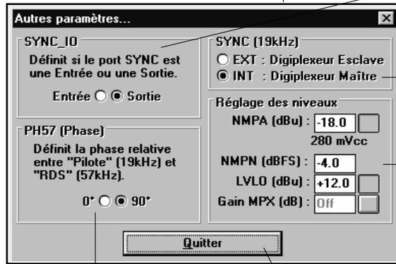
SYNC\_IO : définit si le port SYNC est utilisé en tant qu'entrée ou sortie de signal.
